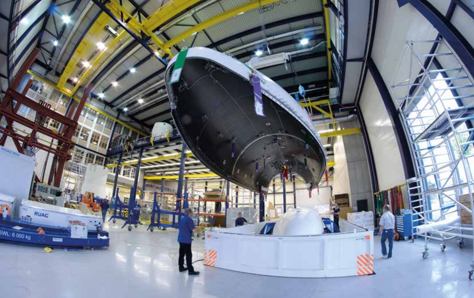
La carenatura per un lanciatore Vega è imballata per la spedizione nello stabilimento RUAG Space, a Zurigo © RUAG
