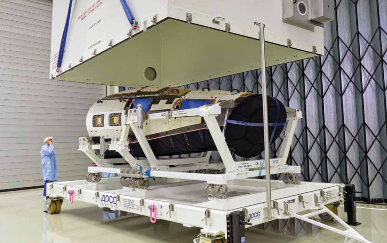
La struttura della navetta Europea IXV (Intermediate eXperimental Vehicle), sviluppata da RUAG Space, sul sistema di sostegno di APCO Technologies © ESA
