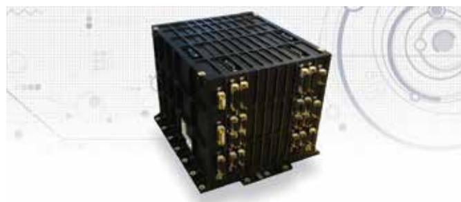
Elettronica di bordo Svizzera: memoria di massa e 'formatting unit' per la missione ESA EarthCARE © Syderal
