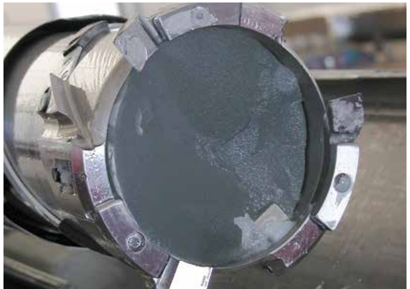
Tête de forage avec carotte de glace de 10 cm de diamètre prélevée au dôme C, en Antarctique. © Jakob Schwander, Universität Bern
