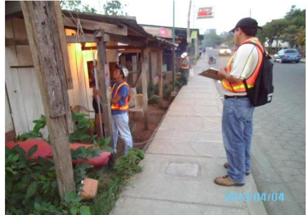
Levantamiento topográfico con nivel de manguera
