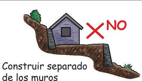
Construir separado de los muros (no adosado y no apoyado).
