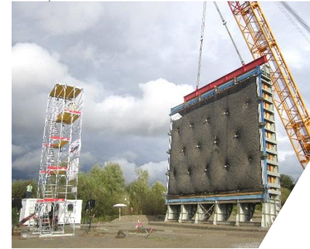
1:1 Ensayo a escala real TECCO®
